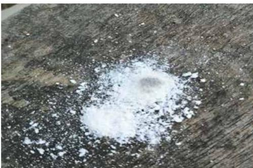
Рис. 3. Выпадение кристаллов оксида натрия  $\text{Na}_2\text{O}$  в газовом расходомере на скважине А-20. Для его образования нужна высокая температура и давление, сопоставимое с самонагревом угля.
